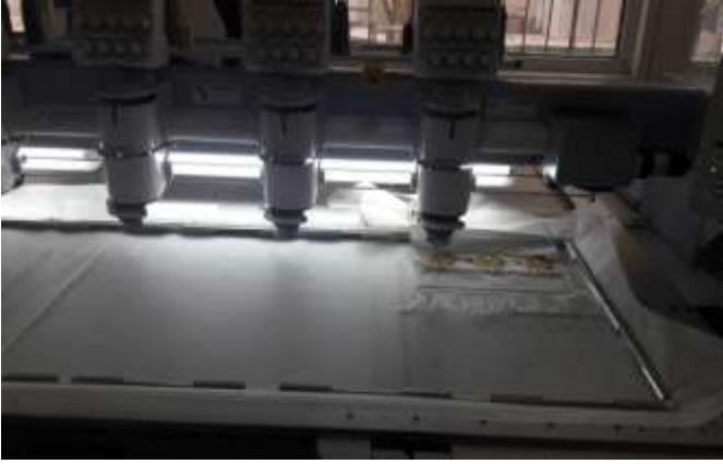
Şekil:13 Accurate4 Desen çizim programında Hesap işi iğne tekniği desenin Bilgisayar destekli nakış makinesinde uygulanması
